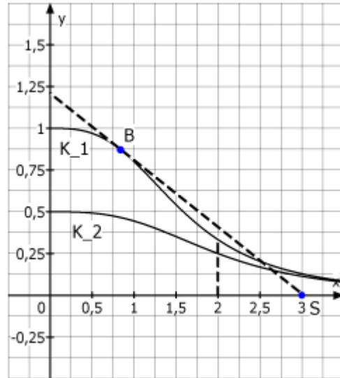
Um den Durchmesser der Düse an der Stelle  $x = 0$  zu bestimmen benötigt man die Tangentengleichung von der Position  $Q(3|0)$  an die Kurve. Gesucht ist der Punkt B, damit dann der Schnittpunkt der Geraden mit der  $y$ -Achse bestimmt werden kann. Da  $K_1$  die äußere Kurve ist, ist in der Funktion  $k = 1$  zusetzen.
