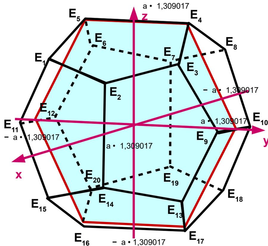
Da der Neigungswinkel zwischen zwei Ebenen  $116,565^\circ$  beträgt, ist der Winkel der entsprechenden Ebenen zu den Koordinatenebenen  $58,2825^\circ$ .
