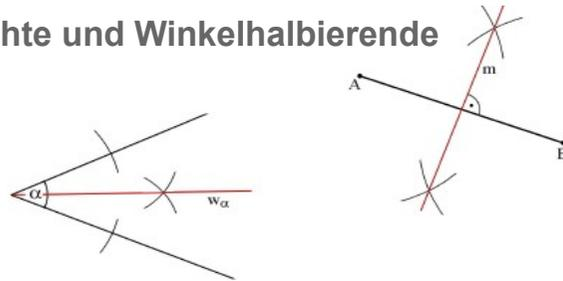
Die Winkelhalbierende  $w_\alpha$  eines Winkels  $\alpha$  ist die Symmetrieachse zu den beiden Schenkeln des Winkels.
