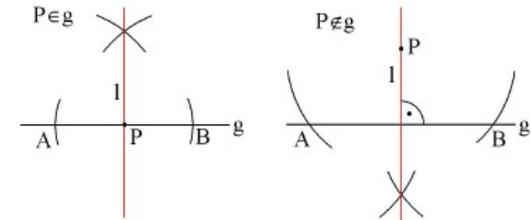
Das Lot  $l$  zu einer Geraden  $g$  durch den Punkt  $P$  ist die Symmetrieachse zu zwei Punkten  $A$  und  $B$  der Geraden, die vom Punkt  $P$  gleich weit entfernt sind.
