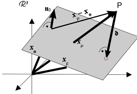
Der Abstandsvektor **d** ist die Projektion des Differenzvektors **x<sub>0</sub> - x<sub>P</sub>** auf den Einheitsvektor in Normalenrichtung **n<sub>0</sub>**.
