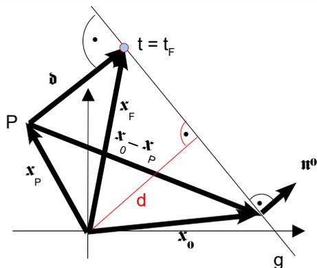
Der Abstandsvektor **d** ist eine Projektion des Verbindungsvektors von P nach F auf den Normaleneinheitsvektor.
