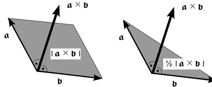
Der Betrag des Vektorprodukts ist gleich dem Flächeninhalt des Parallelogramms, das von den beiden Vektoren aufgespannt wird. Damit ist das Vektorprodukt gut geeignet, die Grundfläche einer (quadratischen oder rechteckigen) Pyramide mittels Vektorrechnung zu ermitteln. Ist die Grundfläche ein Dreieck, ist dieser Betrag mit  $\frac{1}{2}$  zu multiplizieren und man erhält die Dreiecksfläche.
